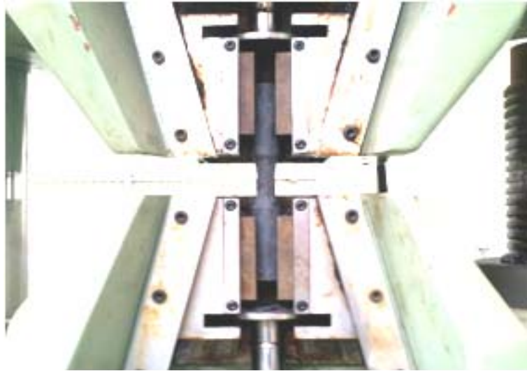
Fig 4.3 인장기에 시편을 물린 사진
