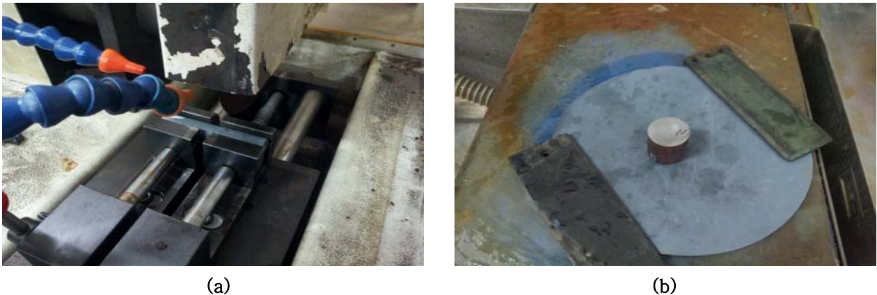
Fig 4.7 폴리싱 하기 전 습식절단기를 이용하는 사진(a)과 폴리싱 작업하는 사진(b)
