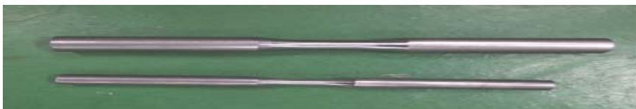
Fig 3.3 시험편 가공 사진 (∅20, ∅30, 각 16EA)
